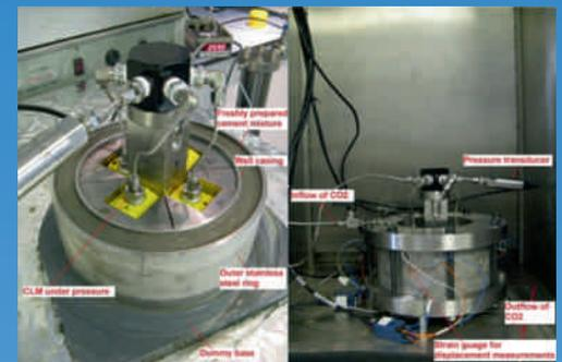
*Der Versuchsaufbau zur Bohrlochzementierung.*
