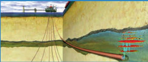
Schematische Darstellung der Sleipner CO<sub>2</sub>-Speicherung mit abgelenkter Bohrung und CO<sub>2</sub>-Fahne im
